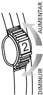
O controlo do volume permite-lhe ajustar a amplificação do seu aparelho. Use o seu dedo para girar a roda de controlo do volume, tal como indicado na figura.
