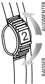
Le contrôle du volume vous permet de régler l'amplification de votre appareil auditif.
