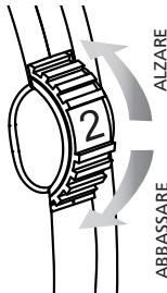
Il controllo del volume consente di regolare l'amplificazione dell'apparecchio acustico.
