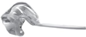
Cuando el canal del molde no permite el paso completo del diámetro del tubo, éste se sustituye por el uso de un codo junto con una parte de tubo.
