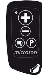
Este control remoto control permite un acceso sencillo a las diferentes funciones del audífono como el ajuste de volumen y los diferentes programas. Incorpora además un indicador visual luminoso que muestra su estado.
